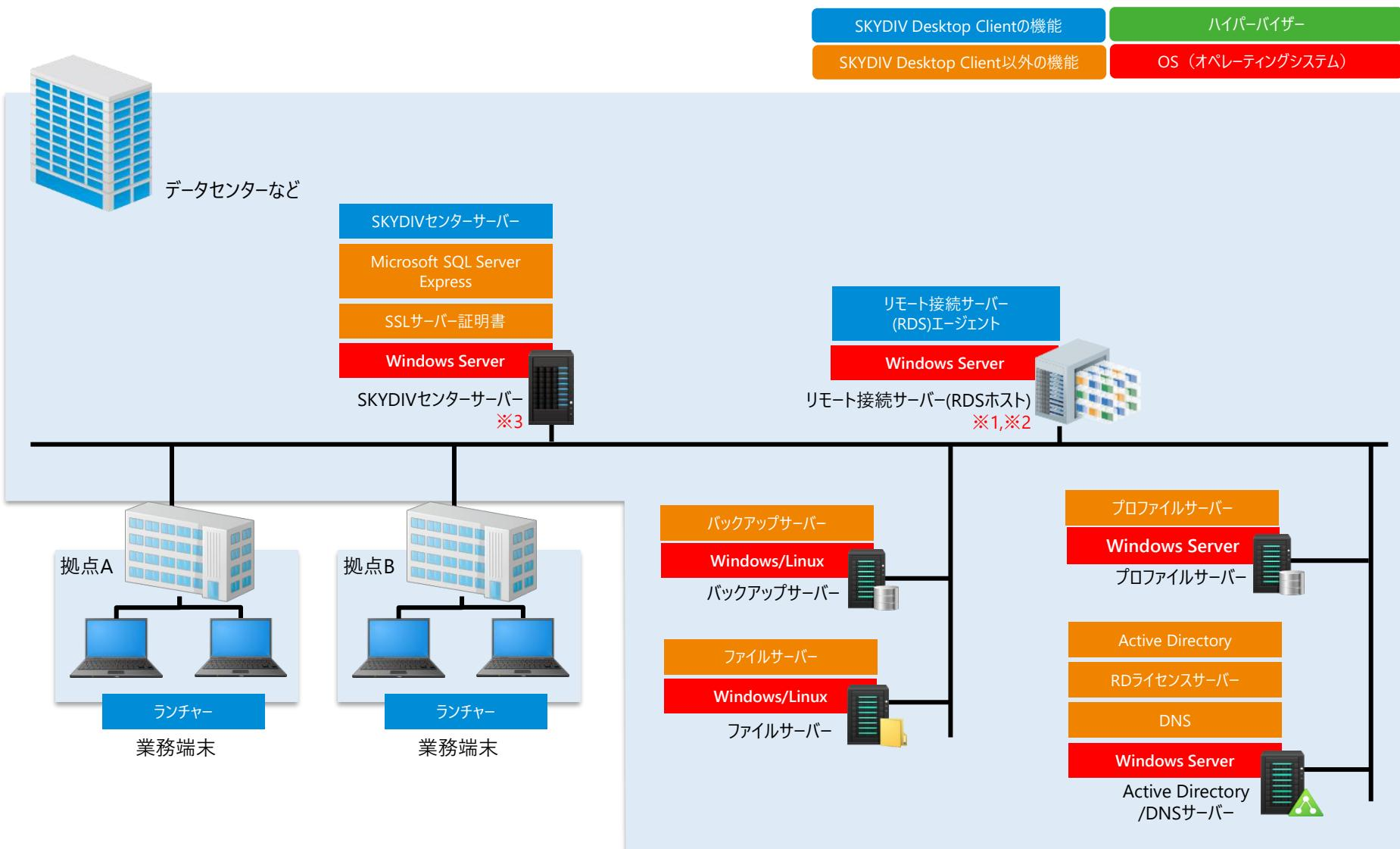
※1 RDS方式の冗長化については、SKYDIVセンターサーバーによる接続先の振り分けによって冗長化することができます。
